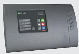
Mit der Weiterentwicklung zum MFT3000 konnten weitere Leser integriert werden. Das farbige 5,7" Touch-Display verfügte über max. 6 Standardtasten und 12 frei programmierbare Funktionstasten. Zusätzliche Zutrittsleser und Barcode-scanner konnten angeschlossen werden. Das MFT30xx besaß 2 potentialfreie Ausgänge und 2 digitale Eingänge und speicherte bis zu 15.000 Buchungen und 5.000 Aufträge.
