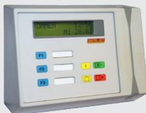
Beim MFT400 konnte zwischen einem Magnet-, einem Infrarot-Barcodedurchzugsleser und einem berührungslosen RFID-Leser gewählt werden. Damit war auch das Ein- und Ausstempeln mittels Transponder möglich. Die Anzahl der freien Funktionstasten wurde – um das Terminalgehäuse kompakter zu gestalten – auf drei reduziert.
