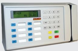
Unser erstes Multifunktionsterminal besaß einen Magnetdurchzugsleser und acht frei programmierbare Funktions-tasten sowie ein Tastenfeld. Später kam noch ein Barcodedurchzugsleser hinzu. Es konnte im Offline-Betrieb eingesetzt werden und besaß 256 KB RAM. Das MFT500 verfügte über 2 potentialfreie Relais, einen Z80 Prozessor, CPM-Betriebssystem und diverse Schnittstellen.
